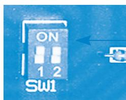
NB : Si les 2 switches sont abaissés (position off), situation anormale, la carte sera en mode alarme dès remise sous tension
