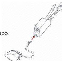
4 Para a ligação do alarme, dispõe de contactos NO/NF (normalmente aberto/normalmente fechado), o poder de corte recomendado = 2A (5A Máx). Ligue o alarme de acordo com o esquema eléctrico da instalação.
